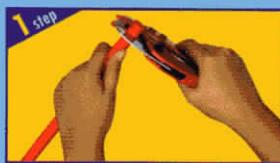
Untuk memotong pipa gunakan gunting pipa agar hasil potongan rapi & rata.
